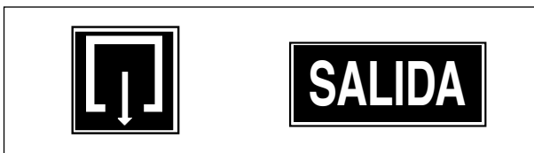
Figura 3. Señalización de salidas habituales según norma UNE 23034
