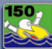
**EN 396** : les gilets de sauvetage 150N sont destinés à une utilisation de navigation au-delà de la bande côtière des 6 miles ou pour des conditions de travail par fort courant. Munis d'un dispositif de déclenchement automatique, ils assurent pratiquement dans tous les cas le retournement d'une personne inconsciente quels que soient les vêtements portés.
