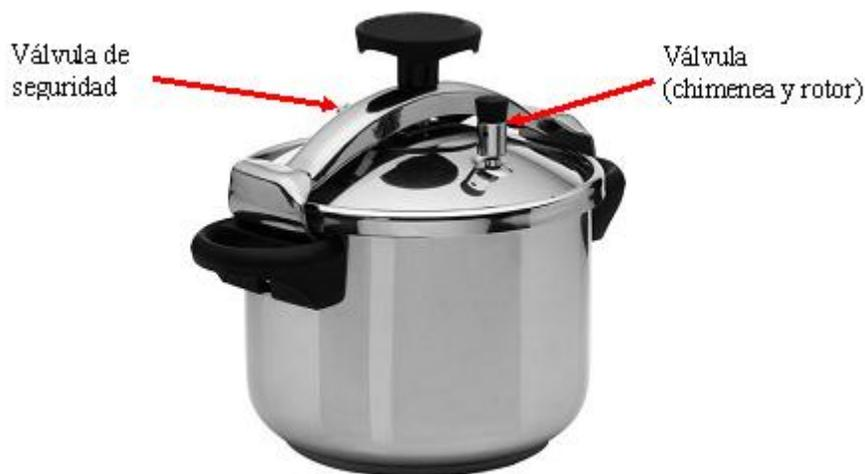
Normalmente la presión se evacúa por una chimenea a la que se acopla una válvula que emite un sonido avisador. Además, otra válvula de seguridad tarada a una presión superior a la de funcionamiento actúa dejando escapar la presión en el caso de que la primera de las válvulas no funcione adecuadamente durante la cocción.
