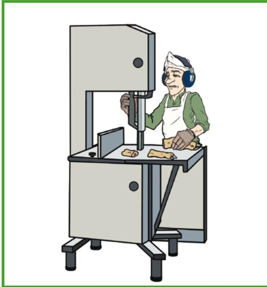
Normalmente para su funcionamiento precisa de la manipulación por parte de, al menos, un operario, el cual, está expuesto a sufrir posibles **heridas de corte en manos y dedos** debido a la hoja de sierra en movimiento así como a **atrapamientos** en los siguientes casos:
