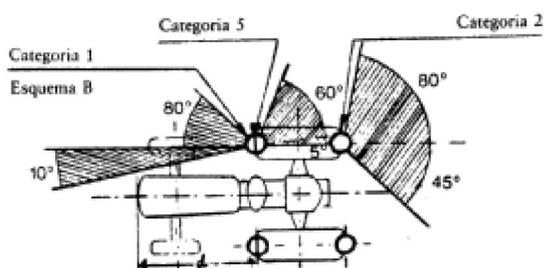
El valor de 5° dado el ángulo muerto de visibilidad, hacia atrás de luz indicadora de dirección repetidora lateral es un límite superior. Este valor podrá ampliarse a 10° cuando sea imposible respetar el límite de 5°.
