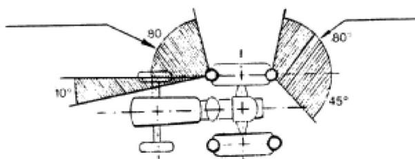
El valor de 10° dado para el ángulo de visibilidad hacia el interior de las luces indicadoras de dirección delanteras podrá reducirse a 3° en los tractores cuya anchura máxima no sea superior a 1 400 mm.
