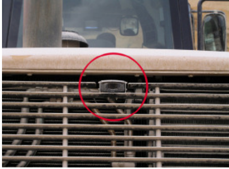
Fotografía 6. Colocación de la cámara
