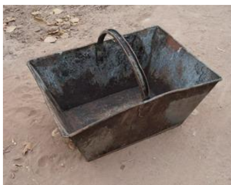
Figura 14 Contenedor para uva (tacho) construido con chapa de acero cincada
